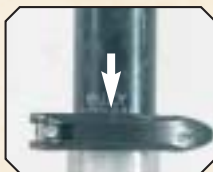
Mindesteinstecktiefe der Sattelstütze
