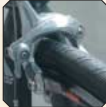
Position der Bremsbeläge zur Felge
